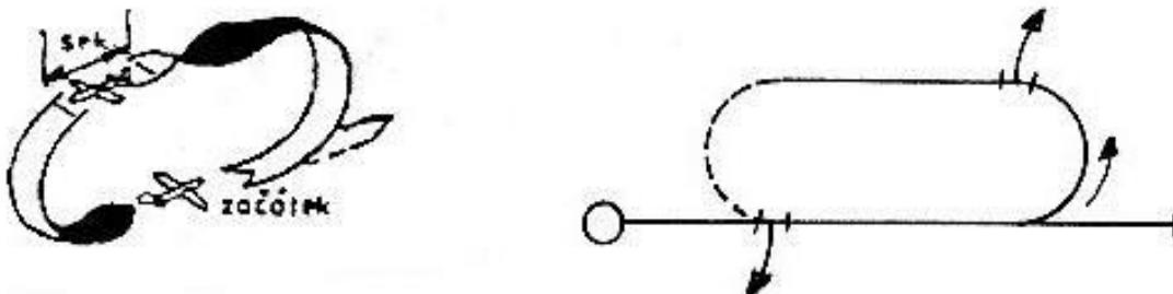
Model provede přitažením 1/2 normálního přemety, provede půlvýkrut do normální polohy, letí přímo a vodorovně, provede 1/2 obráceného přemety a naváže půlvýkrutem do normálního vodorovného letu. Délka rovného úseku mezi půlpřemety včetně půlvýkrutu je stejná jako výška obratu. Jinými slovy, dvojitý překrüt si lze představit jako ovál tvořený dvěma vzájemně se dotýkajícími kruhy. Snížené hodnocení:
