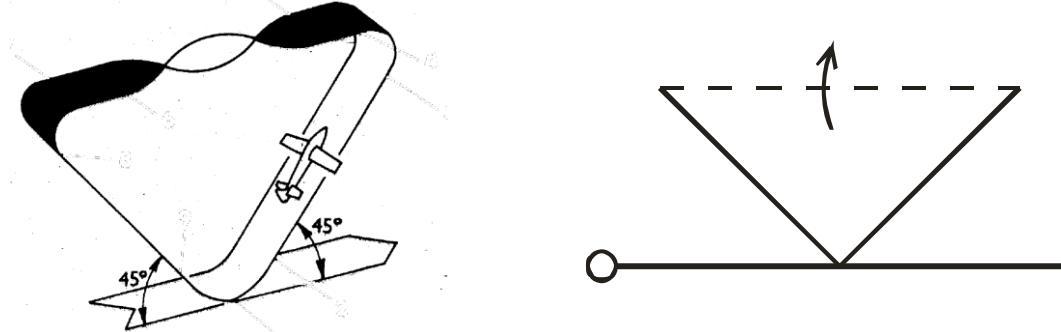
Přitažením model přejde do šikmého vzestupného letu pod úhlem  $45^\circ$ , následně přejde přitažením do vodorovného letu na zádech v horní letové hladině. Provede jednu otočku výkrutu. Přitažením přejde do šikmého sestupného letu pod úhlem  $45^\circ$  a přitažením vyrovná do vodorovného letu.
