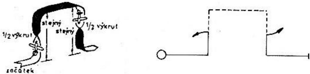
Model přitažením přejde do letu kolmo vzhůru, po výdrži provede půlvýkrut, další výdrž a přitažením přejde do letu na zádech, dalším přitažením přejde do kolmého sestupného letu a po výdrži provede půlvýkrut, znova výdrž a vyrovná do vodorovného letu.
