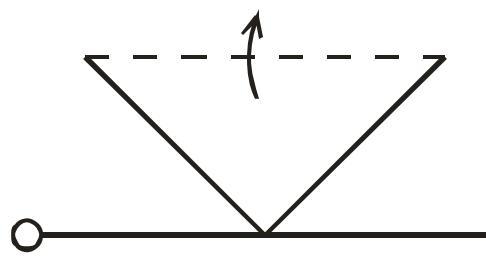
Přitažením model přejde do šikmého vzestupného letu pod úhlem  $45^\circ$ , následně přejde přitažením do vodorovného letu na zádech v horní letové hladině. provede jednu otočku výkrutu. Přitažením přejde do šikmého sestupného letu pod úhlem  $45^\circ$  a přitažením vyrovná do vodorovného letu.
