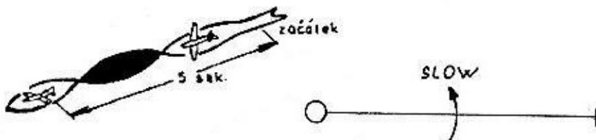
Model provede výkrut  $360^\circ$  v libovolném smyslu tak, aby obrat trval přibližně 5 sekund.
