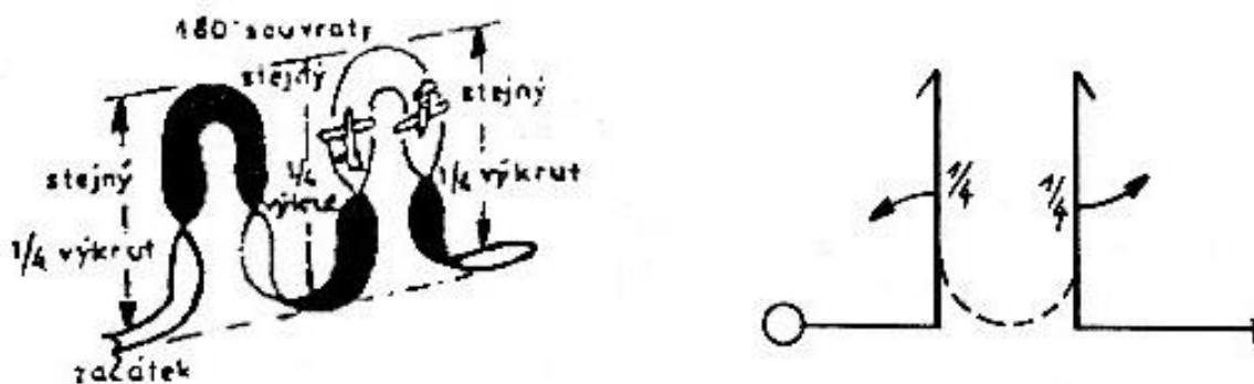
Přitažení přejde model do letu kolmo vzhůru, provede čtvrtvýkrut, potom souvrat o  $180^\circ$ , další čtvrtvýkrut, potom polovinu obráceného přemetu následovaného třetím čtvrtvýkrutem, druhý souvrat o  $180^\circ$  a čtvrtý čtvrtvýkrut s vyrovnáním do vodorovného letu. Čtvrtvýkruty musí být ve stejném směru, první a druhý souvrat mají opačný směr.
